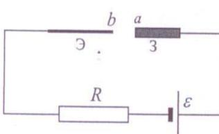
5. Для получения дугового разряда на постоянном токе при электросварке применяется электрическая цепь, показанная на рисунке. Электрическая дуга горит на промежутке  $a-b$  между электродом ( $\mathcal{E}$ ) и металлической заготовкой (3), включенной в цепь. Вольтамперную характеристику дуги (зависимость напряжения на участке  $a-b$   $U_{a-b}$  от электрического тока в дуге  $I$ ) можно приближенно представить в виде
